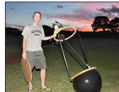
Mike Linnott (LMK) saját készítésű 50cm-es, f/3,6-os gömb-mechanikával rendelkező Newton-távcsövével.
